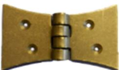
La position des nœuds (et donc de l'axe) par rapport aux planches est une caractéristique importante de la charnière ; ils peuvent être centrés (-O-), ou plus ou moins déhanchés ( \_O\_ ) de manière à permettre l'obtention d'une charnière plate quand elle est ouverte.
