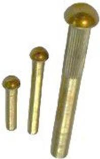
La longueur de l'axe détermine **la hauteur de la charnière**. Il est le plus souvent solidarisé avec l'un ou l'autre des deux charnons (soudure, écrasage, rivetage, vissage, renflement, moletage ou déformation) ; ce n'est toutefois pas le cas des charnières pour lesquelles on privilégie la facilité de démontage ; par exemple charnières "à tige coudée".
